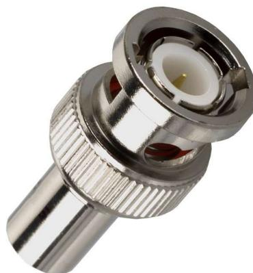
Figura 9: Este conector tiene un centro circular conectado al conductor del cable central y un tubo metálico conectado en el parte exterior del cable. Un anillo que rota en la parte exterior del conector asegura el cable mediante un mecanismo de bayoneta y permite la conexión.
