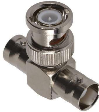
Figura 10: Consiste en dos conectores hembras y uno macho que le dan una forma similar a la letra “T”. Los conectores hembra se conectan a cables coaxiales en la red y el macho va directamente conectado al adaptador de red del ordenador.
