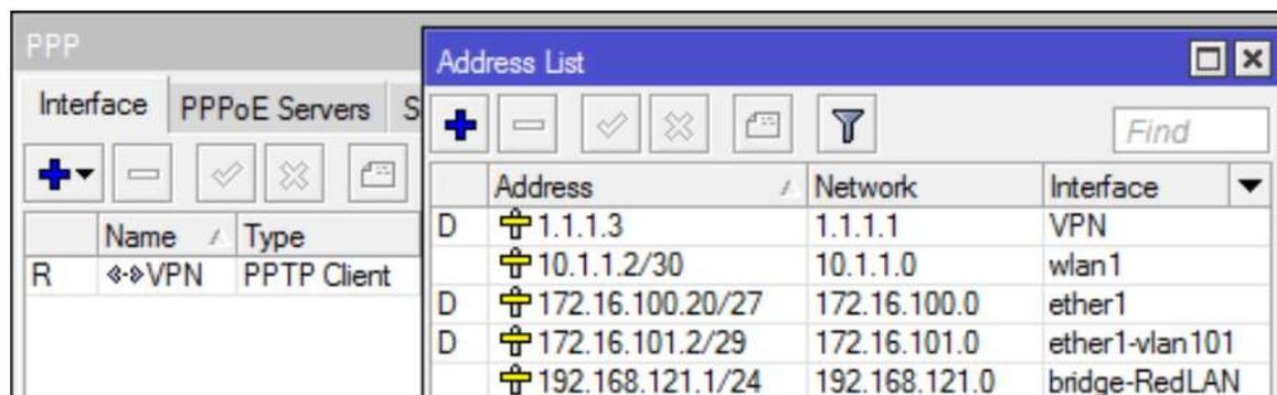
Para acceder a la Red LAN que tiene el Servidor, hay que ingresar una ruta estática a la Red LAN remota a través de la dirección IP que tiene el Túnel en el extremo del Servidor ya que hay es donde se encuentra la Red LAN. En la tabla Routes daremos de alta la siguiente Ruta.
