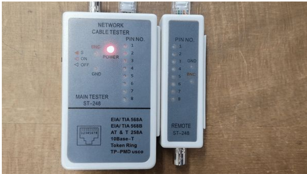
Figura 3.4.8.2. Comprobación Cable Cruzado.
