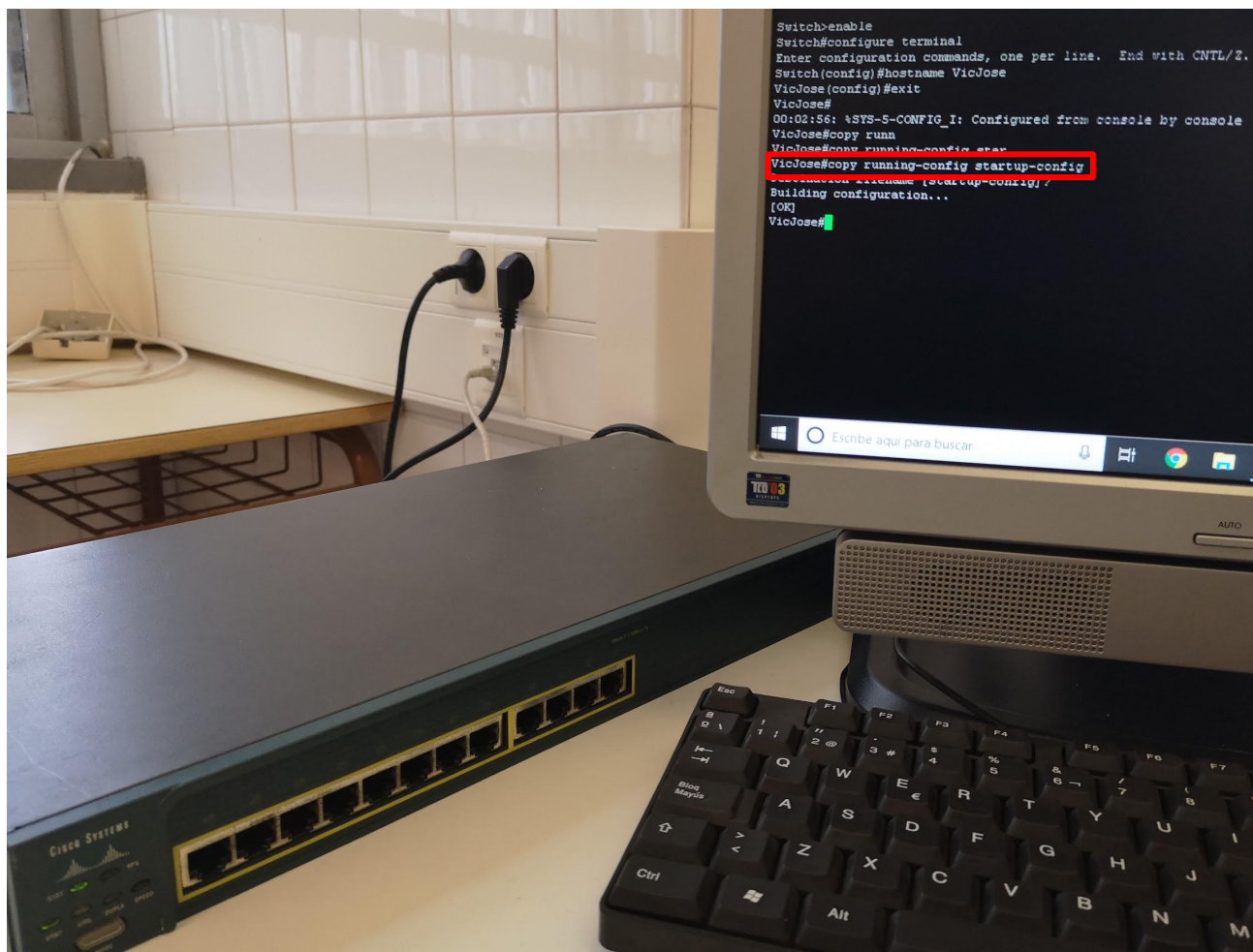
Figura 3.4.5.A. Aplicación del comando “copy running-config startup-config” con switch real.
