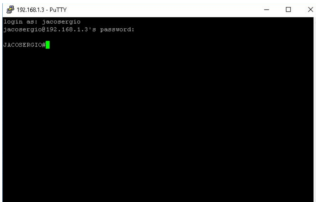
Figura 3.4.7.c Conexión SSH via PUTTY
