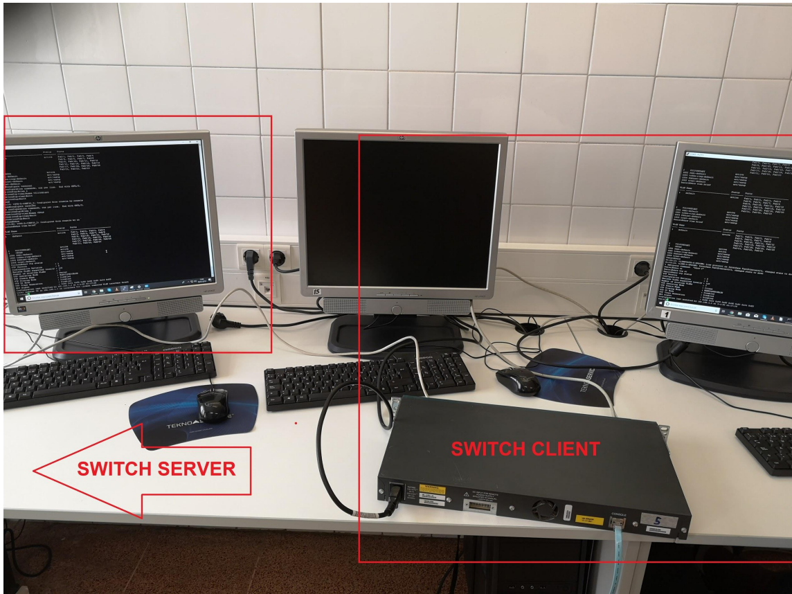
Figura 3.4.8.3. Switch Server y Switch Client conectados mediante cable cruzado.
