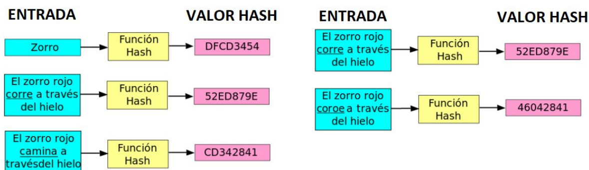
Figura 1.0.E. Proceso de codificación mediante la función HASH.
