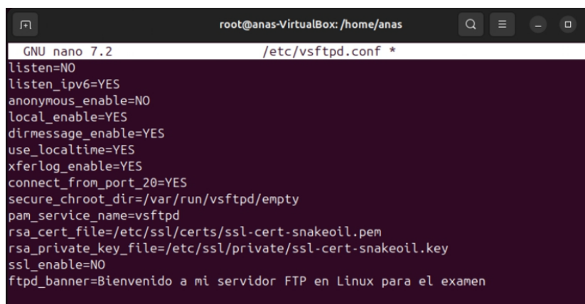
Ilustración 14 - Configuración en Ubuntu virtualizado de vsftpd.conf con mensaje y límite.
